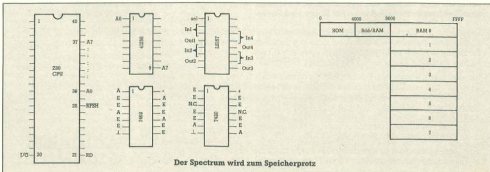
Ein Multiplexereingang liegt auf Plus oder Masse. Das ist je nach Spectrum unterschiedlich. Trennen Sie diese Verbindung und schalten Sie diesen Pin mit Anschluß B zusammen. Anschluß C koppeln Sie mit Pin 1 dieses Multiplexers.
